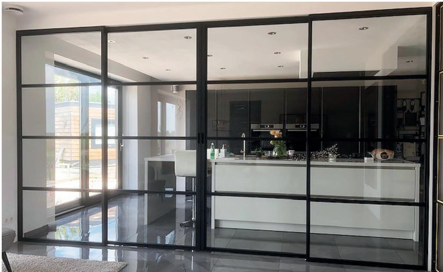
↗ SAGA 150 Syncro duo -järjestelmällä on toteutettu myös nämä upeat lasiliukuoventeillit ja olohuoneen välisiin. Vain yhtä ovea liikuteltaessa molemmat liukuovet avautuvat samanaikaisesti.
